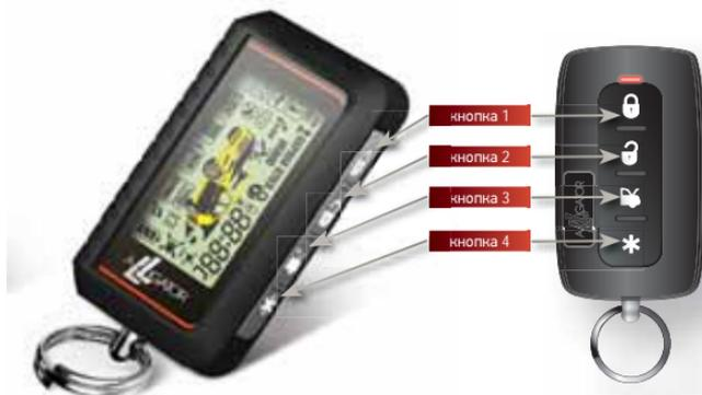
Брелоки-передатчики позволяют управлять всеми функциями системы. Помимо этого, каждый раз при использовании передатчиков система будет посылать специальные сигналы, подтверждающие исполнение той или иной команды ("обратная связь"), а встроенные в брелоки-передатчики миниатюрные динамики будут подавать соответствующие звуковые сигналы подтверждения. Кроме этого, на ЖК-дисплее 5-кнопочного брелока будет появляться соответствующая индикация
